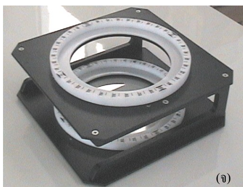
รูปที่ 7 ชุดทดลอง FL210 Overhead Polariscope ของ Gunt
